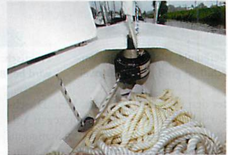
Gekonnt: Die Trommel der Rollreffanlage ist leistungsfördernd unter Deck montiert
