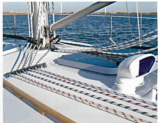
Effektive Lösungen an Deck: Ankerkasten mit versenkter Rollanlagen-Trommel, solide Pinnenaufhängung, Leinenumlenkung ins Cockpit
