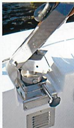
Effektive Lösungen an Deck: Ankerkasten mit versenkter Rollanlagen-Trommel, solide Pinnenaufhängung, Leinenumlenkung ins Cockpit
