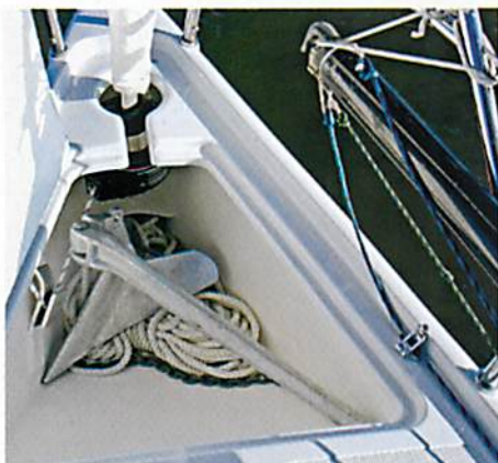
Effektive Lösungen an Deck: Ankerkasten mit versenkter Rollanlagen-Trommel, solide Pinnenaufhängung, Leinenumlenkung ins Cockpit
